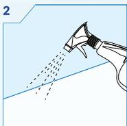
Sử dụng dung môi để loại bỏ hoàn toàn tất cả bụi bẩn và các chất như dầu mỡ, bụi, nước, tạp chất, chất trám cũ hoặc lớp phủ bảo vệ.
